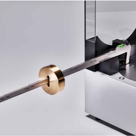
Статическая квалификация с одним эталонным весом SmartCal™, который может применяться в нескольких положениях
