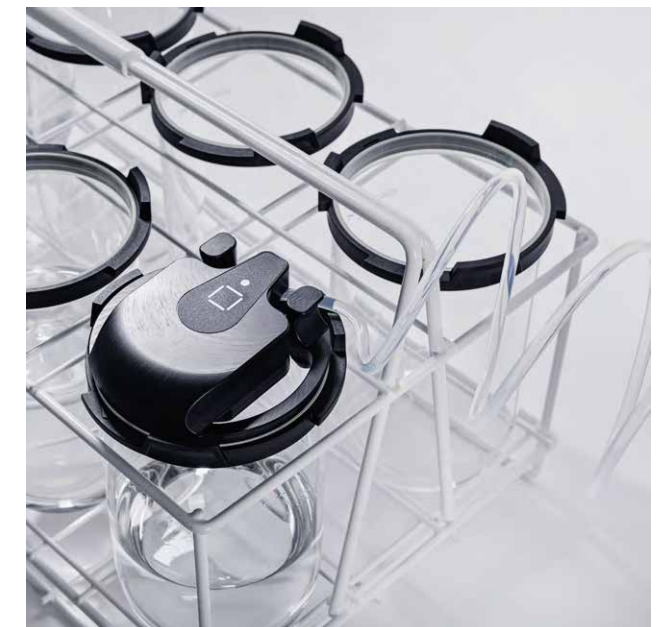
Наполнение стаканов на центральной станции для работы со средами
