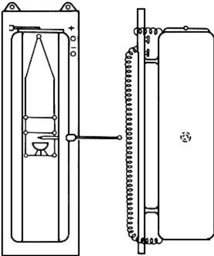
В.2.1. Печь, состоящая из вертикальной трубы внутренним диаметром 100 мм и длиной 500 мм, короткий конец которой загнут для ввода в нее термометра. Она равномерно обмотана проволокой и потребляет энергию 1 кВт. Печь снабжена теплоизоляцией и аппаратурой для контроля температуры.
