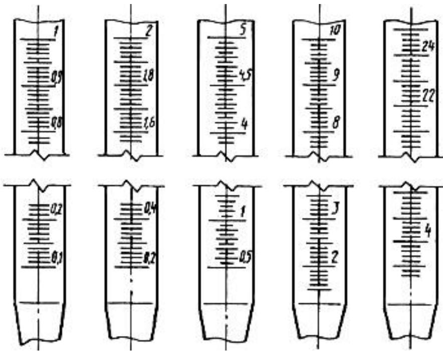
Примечание. В практике применяют выдувные пипетки, градуированные так же, как и пипетки типа 3 по ГОСТ 29228, предназначенные для слива жидкости от верхней нулевой точки до требуемой отметки (при сливе жидкости - до сливного кончика).
