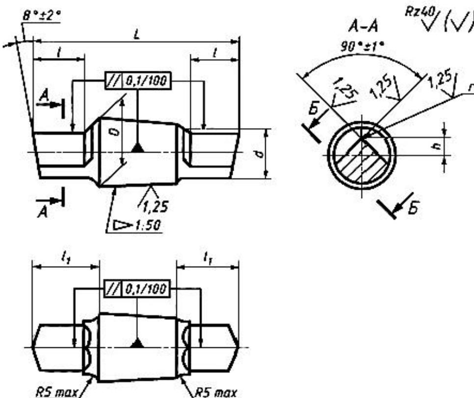
Примечание. Допускается привязку размера  $l$  проводить: для одноконсольных открытых призм (тип 3, исполнение 1) от торца конической части (чертеж 4), для двухконсольных открытых призм (тип 4, исполнение 1) от торца малого диаметра конической части (чертеж 6).
