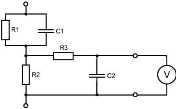
R1 - 1500 Ом с относительным допуском  $\pm 5\%$ ; R2 - 500 Ом с относительным допуском  $\pm 5\%$ ; R3 - 10 кОм с относительным допуском  $\pm 5\%$ ; C1 - 0,22 мкФ с относительным допуском  $\pm 10\%$ ; C2 - 0,022 мкФ с относительным допуском  $\pm 10\%$
