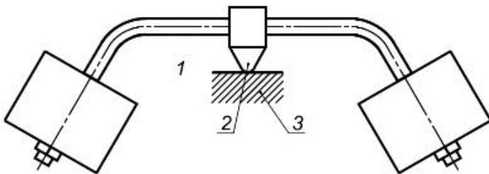
1 - испытуемая часть; 2 - сферическая часть устройства; 3 - опора
