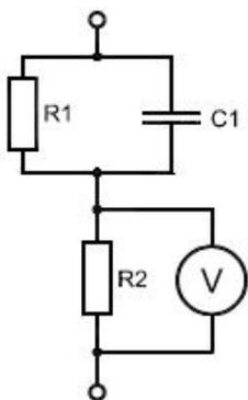
R1 - 1500 Ом с относительным допуском  $\pm 5\%$ ; R2 - 500 Ом с относительным допуском  $\pm 5\%$ ; C1 - 0,22 мкФ с относительным допуском  $\pm 10\%$
