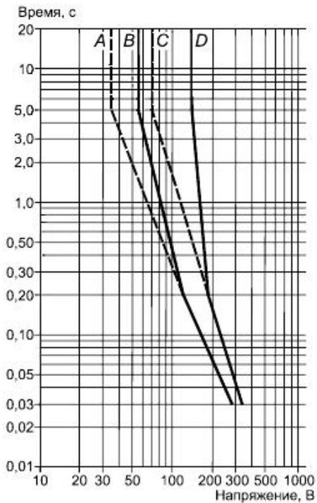
*A* - значение переменного напряжения во влажных условиях; *B* - значение переменного напряжения в сухих условиях; *C* - значение постоянного напряжения во влажных условиях; *D* - значение постоянного напряжения в сухих условиях
