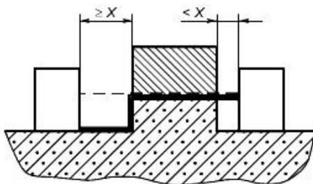
Пример 7 - Траектория включает в себя несцементированный стык с пазом с одной стороны менее  $X$  и с пазом с другой стороны, равным или более ширины  $X$ .
