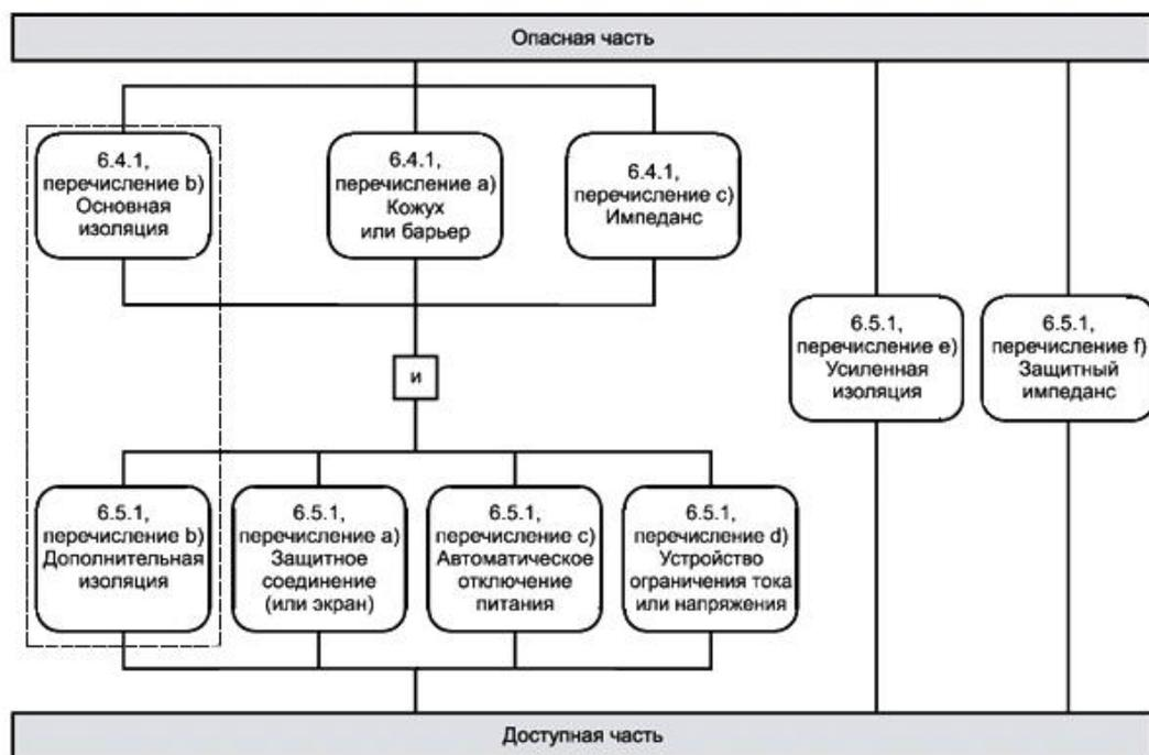
Рисунок 4 - Применяемые средства защиты от поражения электрическим током
