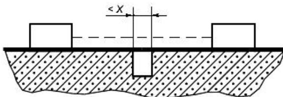
Пример 1 - Траектория включает в себя паз с параллельными или сходящимися сторонами любой глубины, шириной менее  $X$ .
