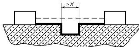
Пример 2 - Траектория включает в себя паз с параллельными сторонами любой глубины, равный или более  $X$ .
