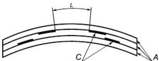
$L$  - расстояние между соседними проводниками;  $A$  - слои тонкопленочного материала, например ленты полиэстерной пленки;  $C$  - проводники
