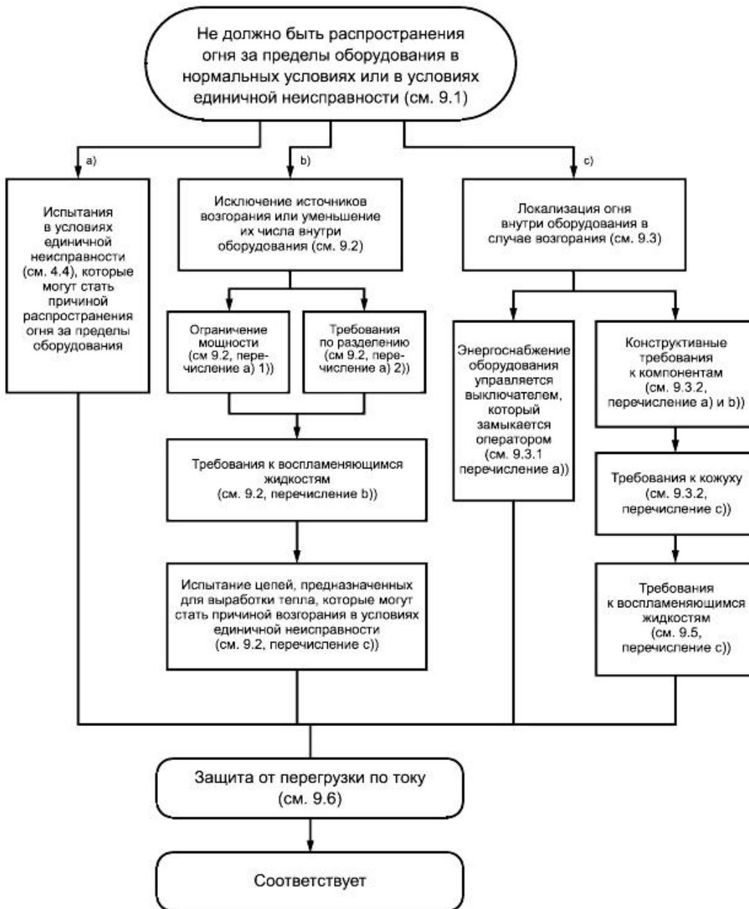
Рисунок 11 - Схема требований к защите от распространения огня
