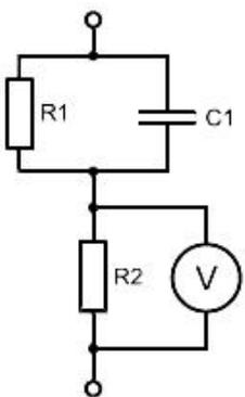
R1 - 375 Ом с относительным допуском  $\pm 5\%$ ; R2 - 500 Ом с относительным допуском  $\pm 5\%$ ; C1 - 0,22 мкФ с относительным допуском  $\pm 10\%$
