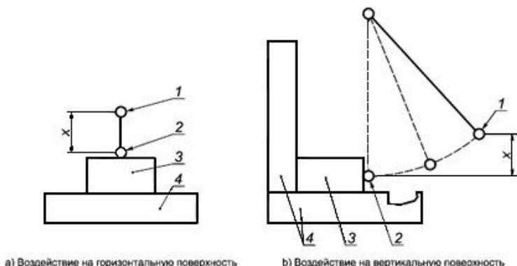
1 - начальное положение шара; 2 - положение шара во время удара; 3 - испытываемый образец; 4 - твердая опорная поверхность
