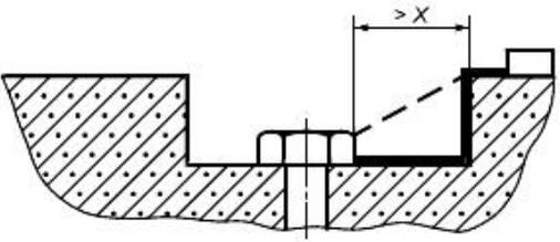
Пример 10 - Достаточно широкий просвет между головкой винта и стенкой углубления следует учитывать.
