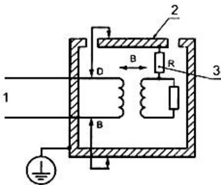
1 - опасная цепь; 2 - доступная часть, не связанная с зажимом защитного заземления; 3 - высокое сопротивление, которое в комбинации с основной изоляцией образует защитный импеданс (см. 6.5.3)
