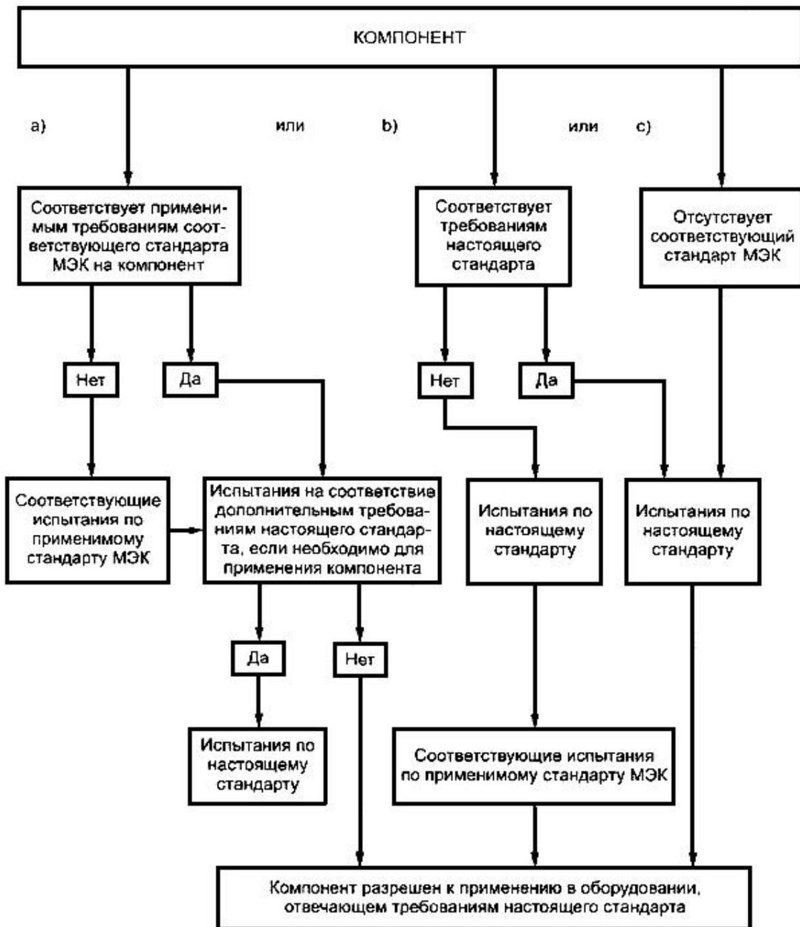
Рисунок 5 - Порядок подтверждения соответствия компонента требованиям настоящего стандарта по 14.1, перечисления а), b), с)
