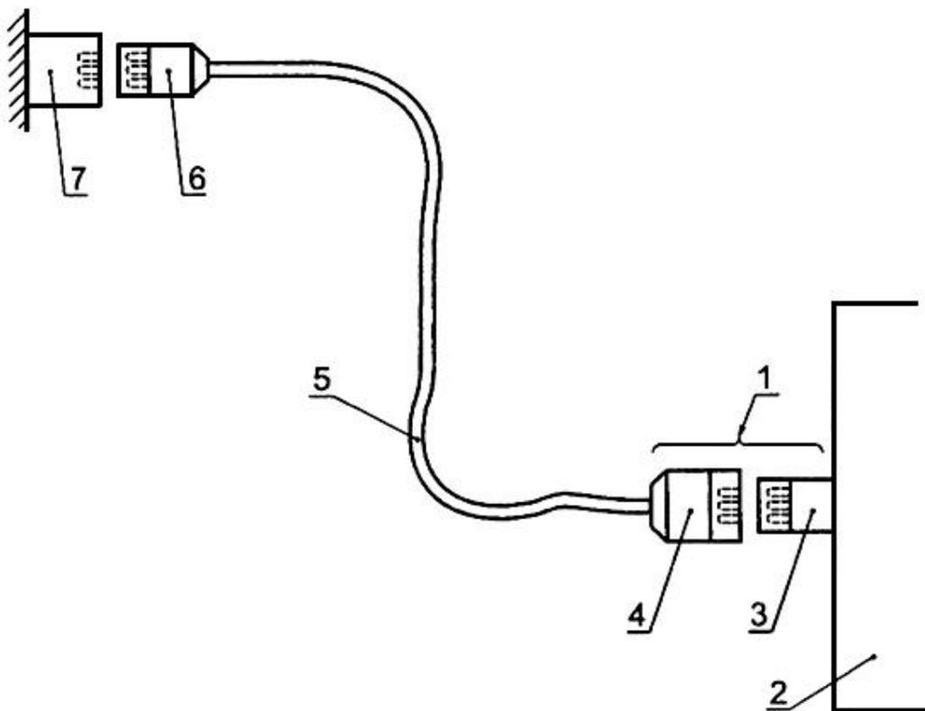
1 - приборный соединитель; 2 - оборудование; 3 - сетевая приборная вилка; 4 - сетевая кабельная розетка;
