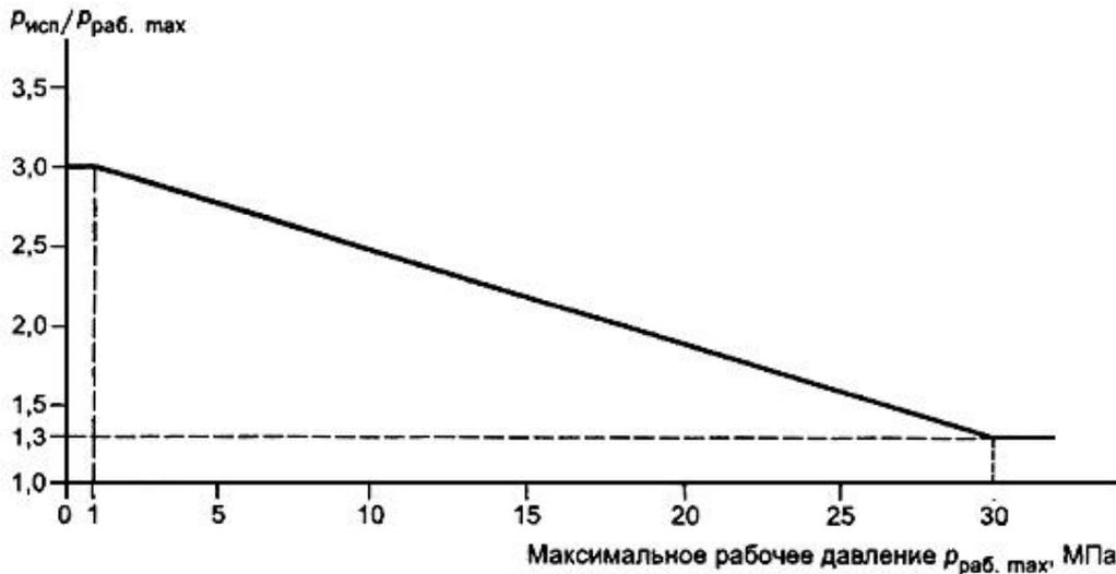
Рисунок 4 - Поправочный множитель для определения испытательного давления
