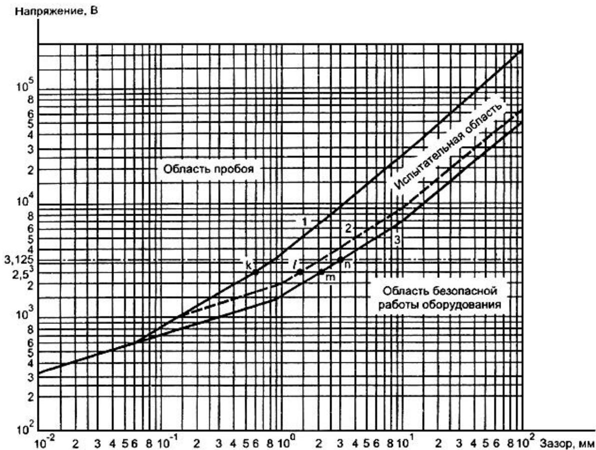
1 - однородная конструкция, испытательное напряжение частотой 50/60 Гц и импульсное "стандартное" испытательное напряжение 1,2/50 мкс; 2 - неоднородная конструкция, импульсное "стандартное" испытательное напряжение 1,2/50 мкс (только импульсное перенапряжение); 3 - неоднородная конструкция, испытательное напряжение частотой 50/60 Гц (рабочее напряжение без импульсного перенапряжения)
