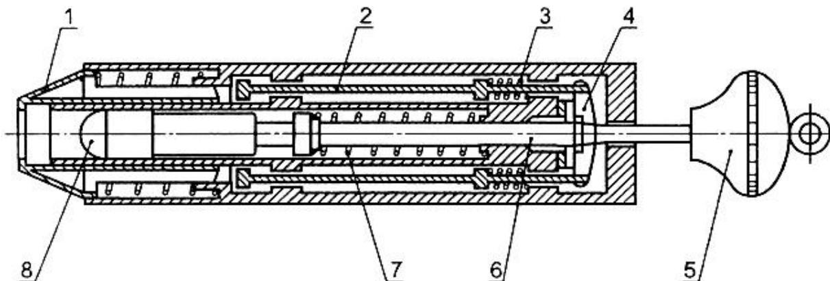
1 - подпружиненный возвращаемый конус; 2 - стержень спускового механизма;
