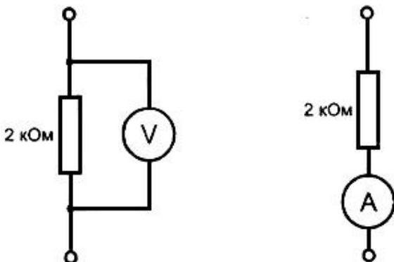
V - вольтметр, А - амперметр
