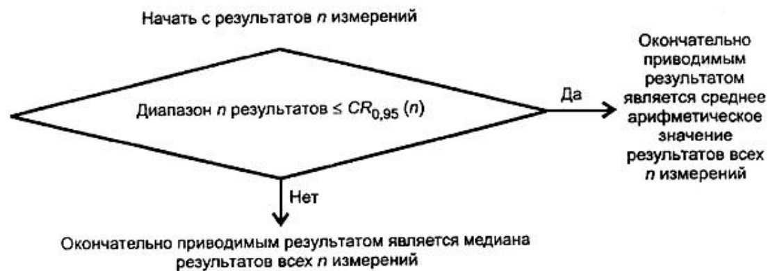
Рисунок 5 - Метод проверки приемлемости результатов измерений, полученных в условиях повторяемости, при первоначальном получении n результатов измерений и условии, что получение результатов измерений является дорогостоящим (вариант В)
