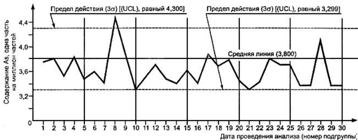
Рисунок 11 - Контрольная карта Шухарта для средних значений \bar{x} содержания мышьяка в оксиде цинка
