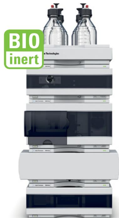
Система ВЭЖХ Agilent 1260 Infinity Bio-inert с четырехканальным насосом
